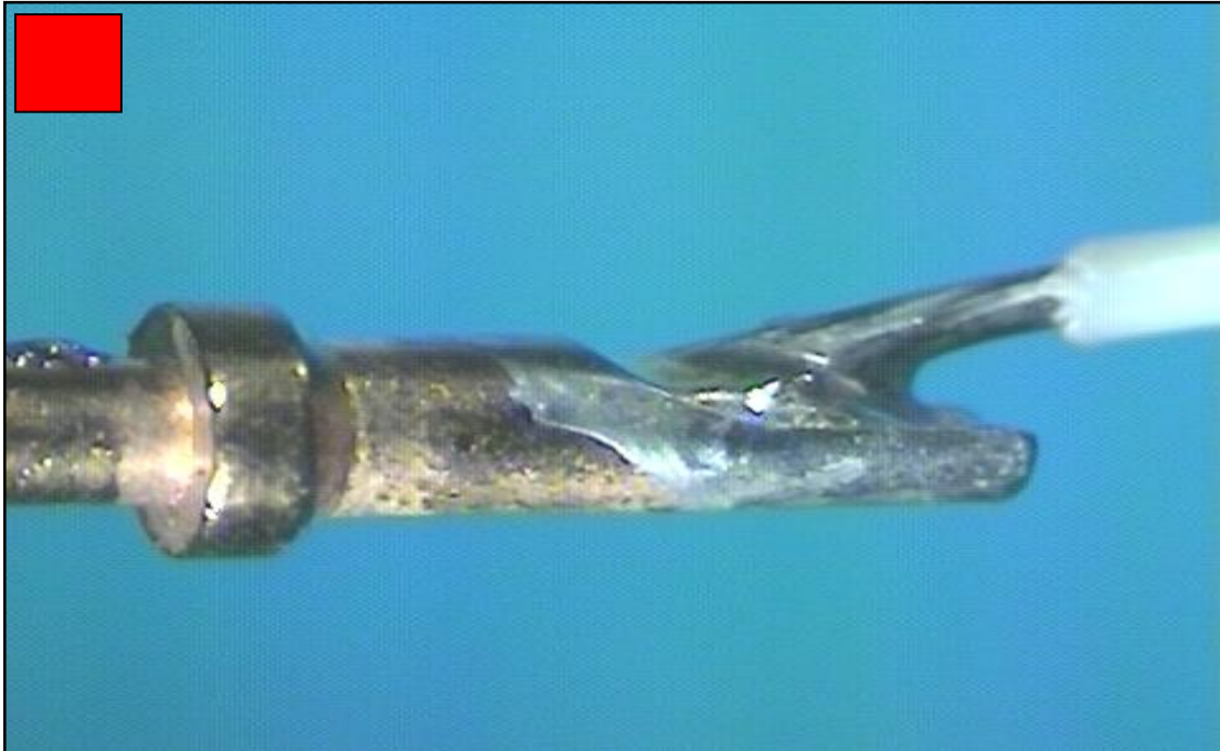
Obr. 27. Pájené komponenty nejsou v ose a pájka netvoří plynulý konvexní přechod. Neakceptovatelný spoj.
