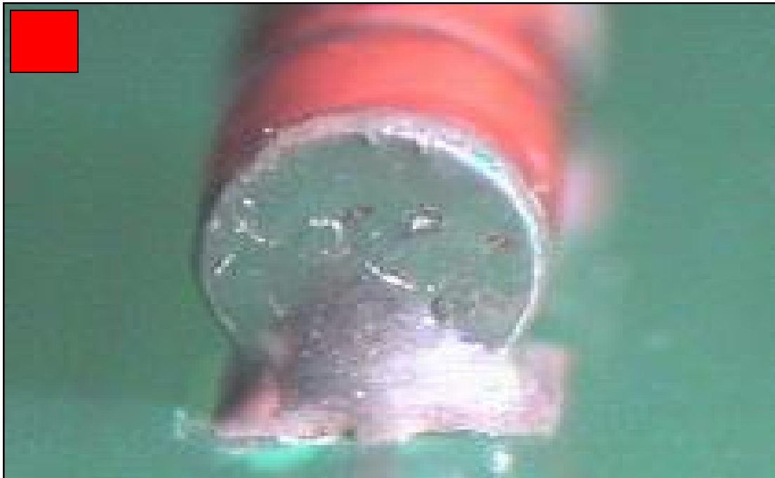
Obr. 37. Nedostatečné množství pájky a její roztroušenost determinuje neakceptovatelný spoj u komponentu SMD v provedení MELF.
