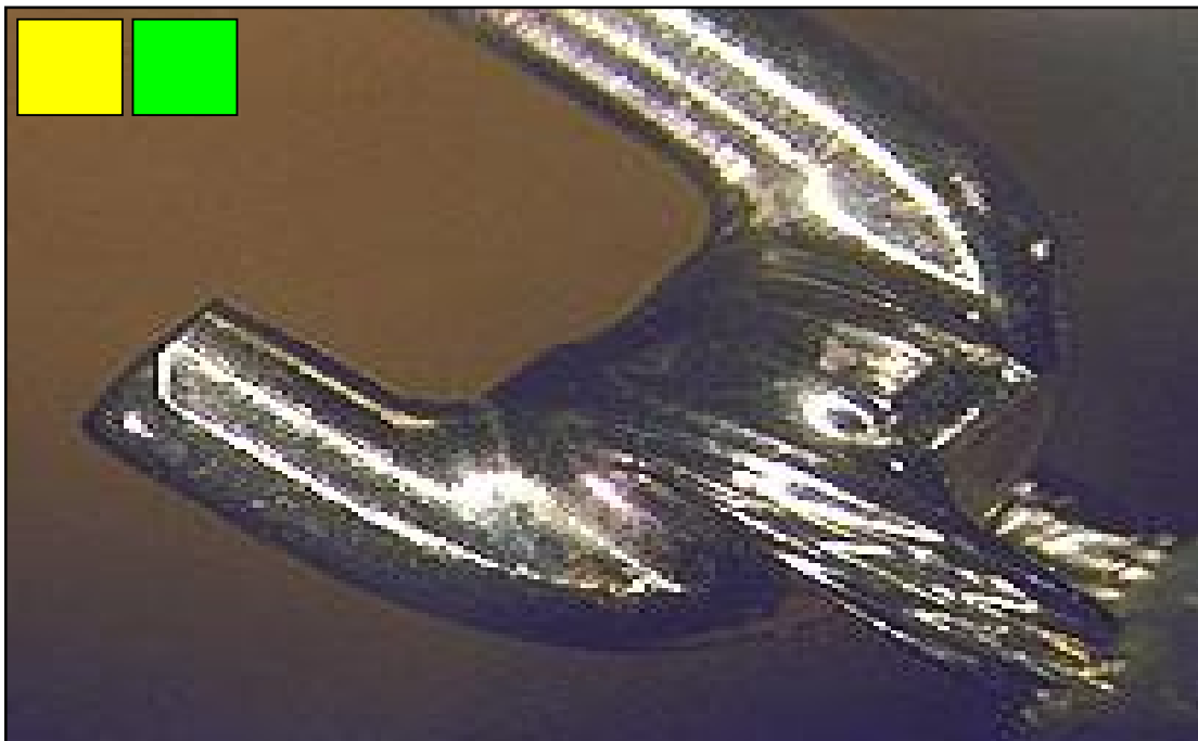
Obr. 20. Pájený spoj je kvalitní na hranici přijatelnosti. Minimum pájky.
