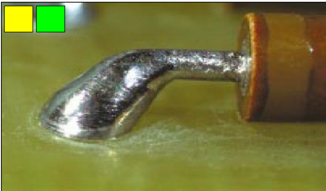
Obr. 44. Pájka vzlíná po vývodu součástky, ale nedotýká se pouzdra součástky. Ještě akceptovatelný spoj.
