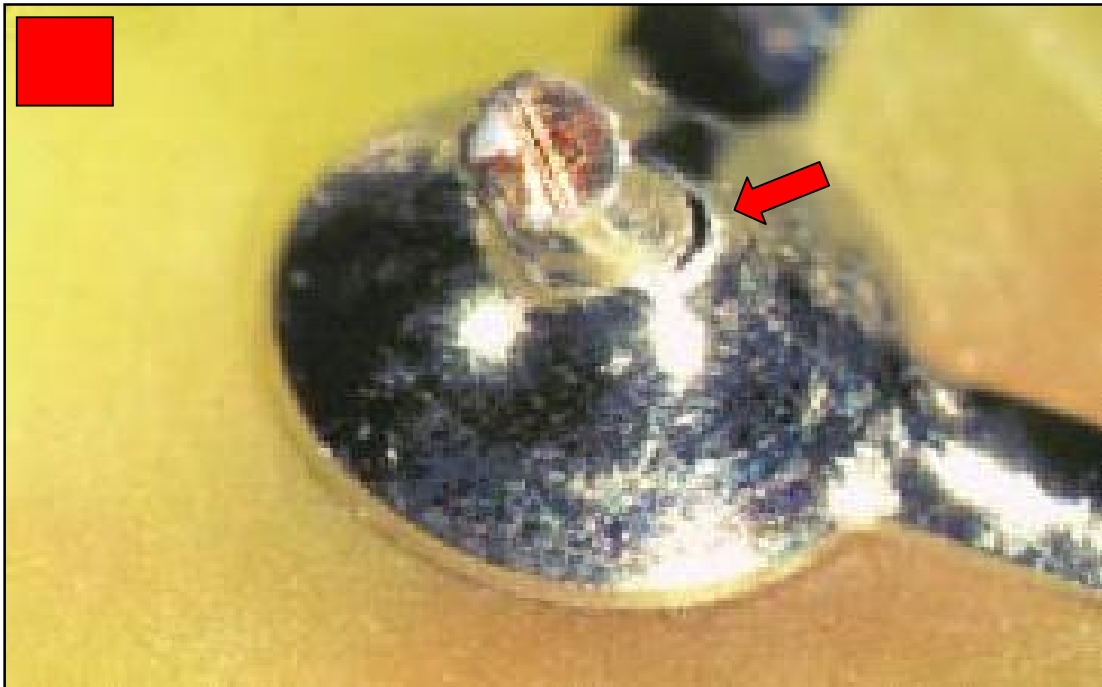
Obr. 43. Prasklý spoj mezi pájkou a vývodem součástky. Neakceptovatelné.
