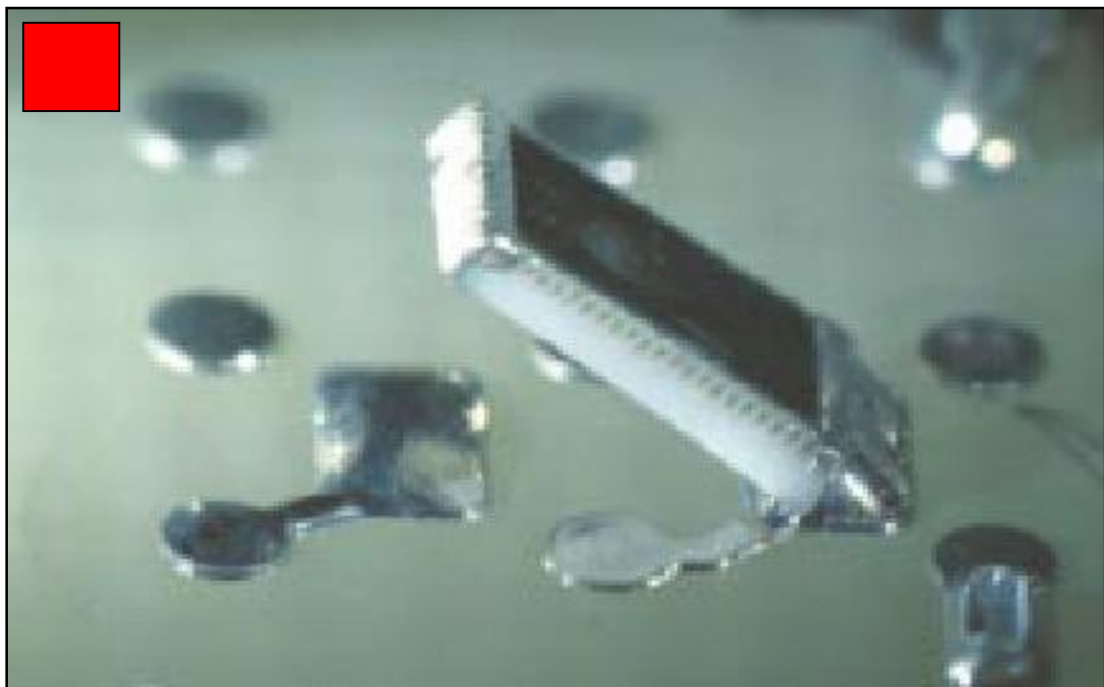
Obr. 50. Zvednutá součástka při operaci strojního pájení - efekt náhrobního kamene (Tombstoning effect). Neakceptovatelné.
