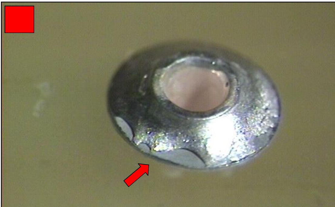
Obr. 28. Nedokonalé pokrytí plošky pájkou u vícevrstvé DPS.
