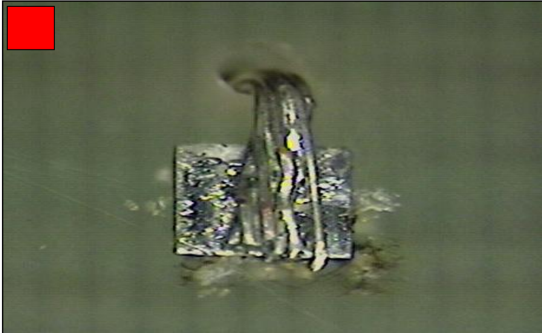
Obr. 29. Rozpletená a deformovaná lanka vodiče na DPS představují neakceptovatelný spoj s rizikem poruch a nespolehlivosti EZS.
