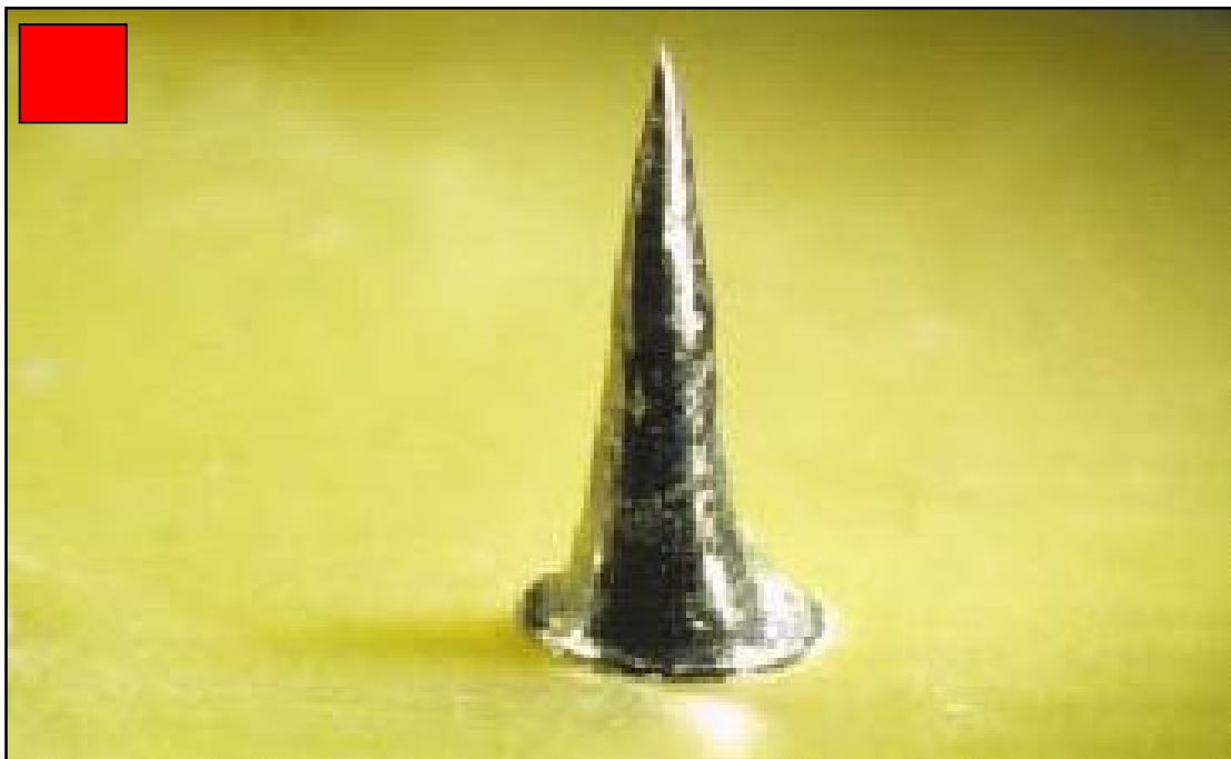
Obr. 46. Obrysy vývodu komponentu nejsou v pájeném spoji rozeznatelné. Kvalitu pájeného spoje nelze posoudit. Nadměrná délka vývodu nad DPS. Neakceptovatelné.
