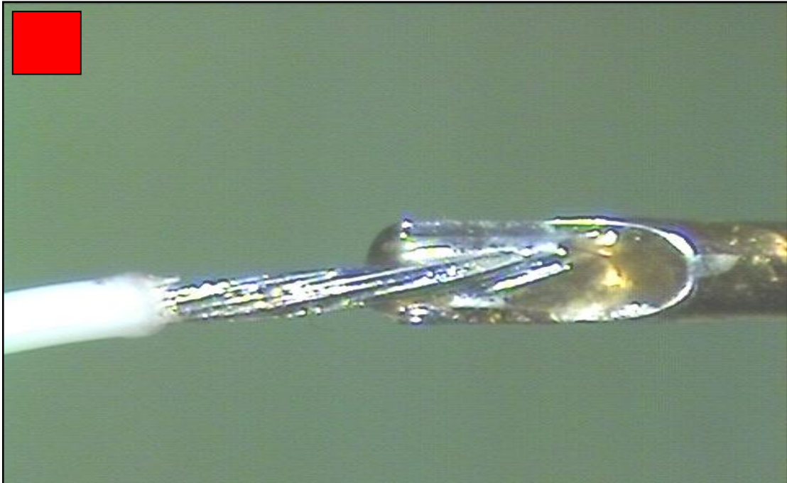
Obr. 25. Pájené komponenty nejsou v ose a v dostatečném překrytí. Málo pájky. Neakceptovatelný spoj.
