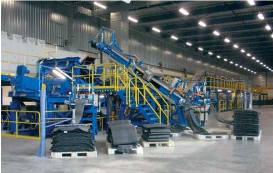
Obr. 24: Zásobovanie studenou kaučukovou zmesou linky Quadroplex [7].
