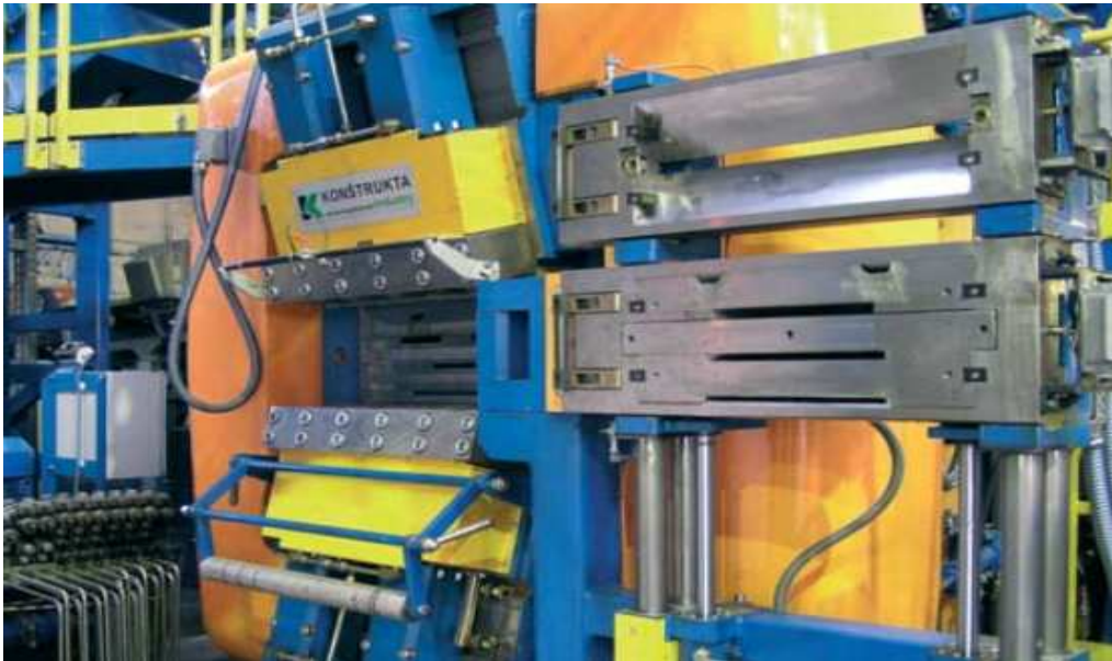
Obr. 26: Vytlačovací hlava s predšablónou a tokovými kanálmi každého extrúdera [7].
