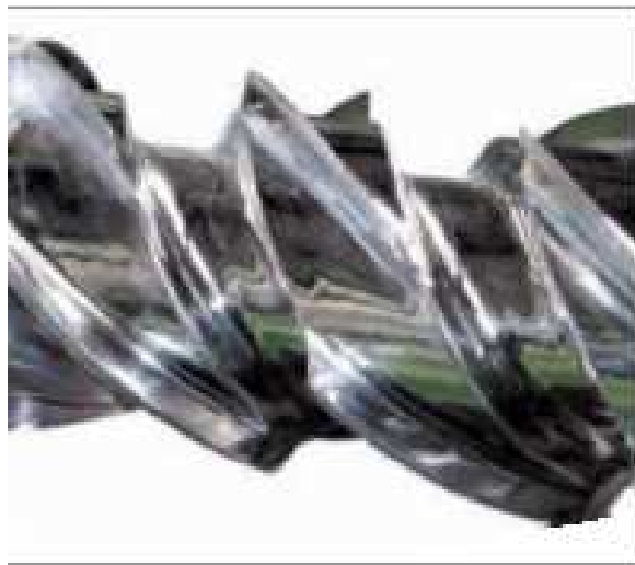
Obr. 5: Detailný pohľad na indukčne tvrdenú závitovku [8].
