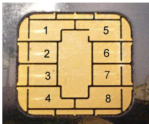
Obr. 3 Vodivé kontakty z čipu na kartě s popisem kontaktů
