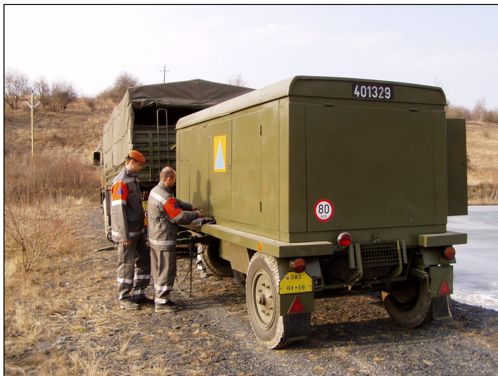
Obr. 23. Prostředky NZPV - úpravna vody ÚV 2000
