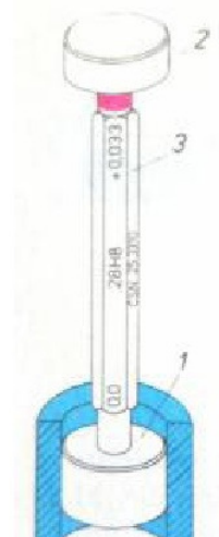
Obr. 10 – Válcový kalibr (1 – dobrá strana, 2- zmetková strana, 3 – držák s údajem o průměru a toleranci)
