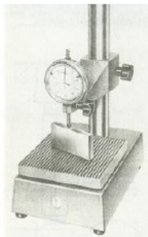
Obr. 12 – Upínací přípravek pro komparační přístroje [1]
