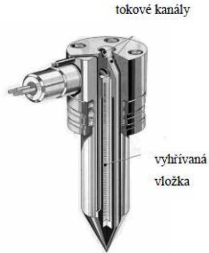
Obr. 10. Tryska s vnitřním topením [9]
