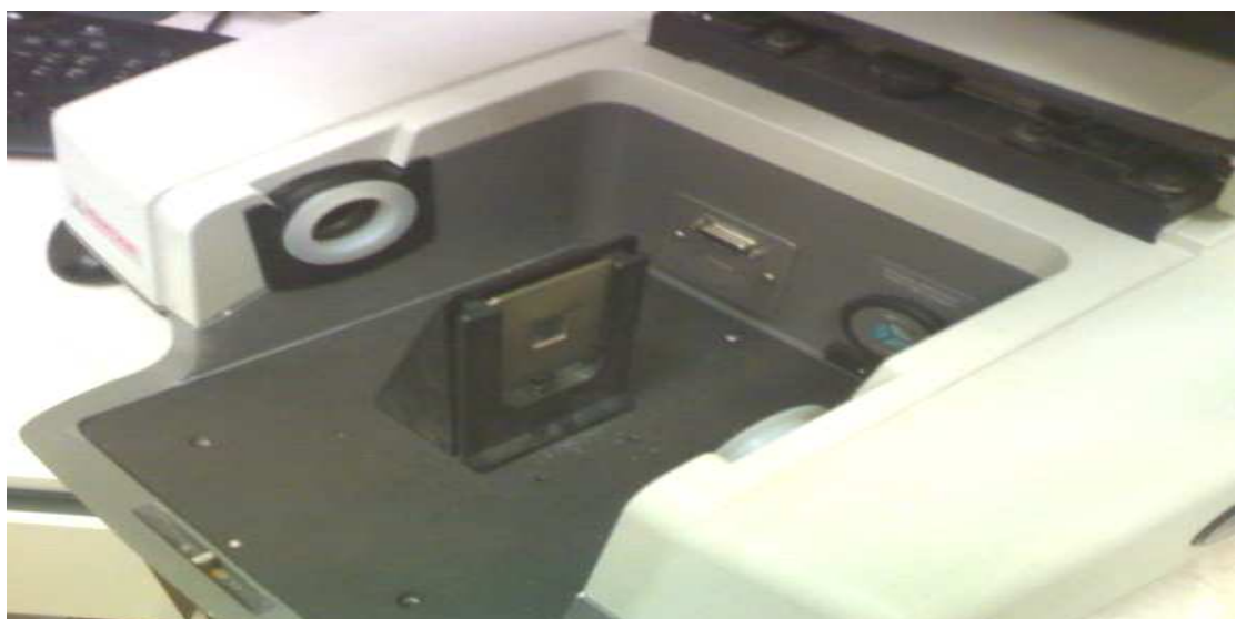
Obr. 15: FTIR Avator 320 NICOLET – s nadstavcem pro měření transmisních spekter.
