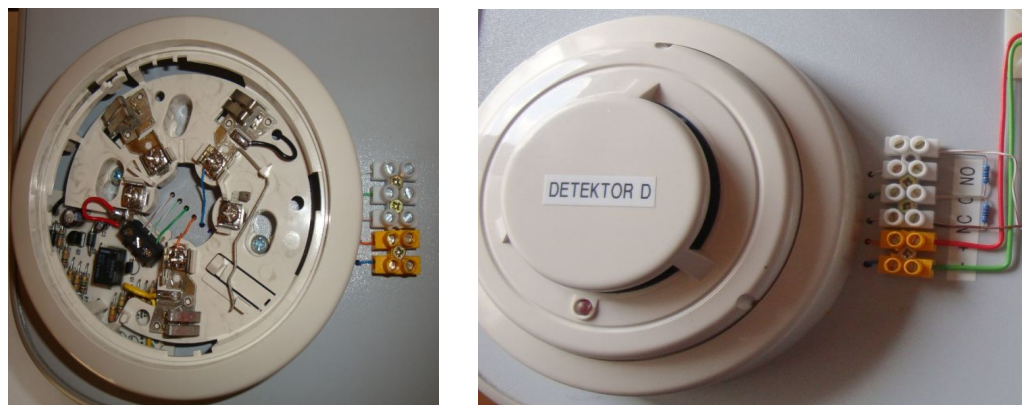
Obrázek 14: Správně zapojený DETEKTOR D
