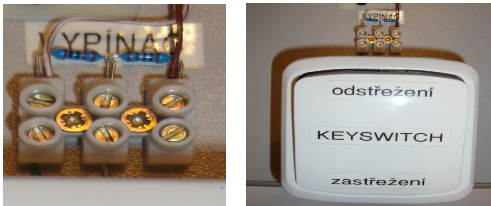
Obrázek 16: Správně zapojený DVOUSTAVOVÝ SPÍNÁČ KEYSWITCH
