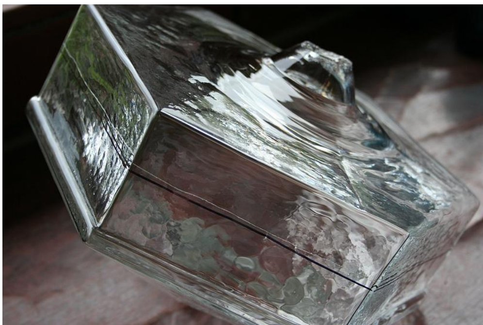
Obr. 55. Luxfera s kopnou určenou pro odbroušení
