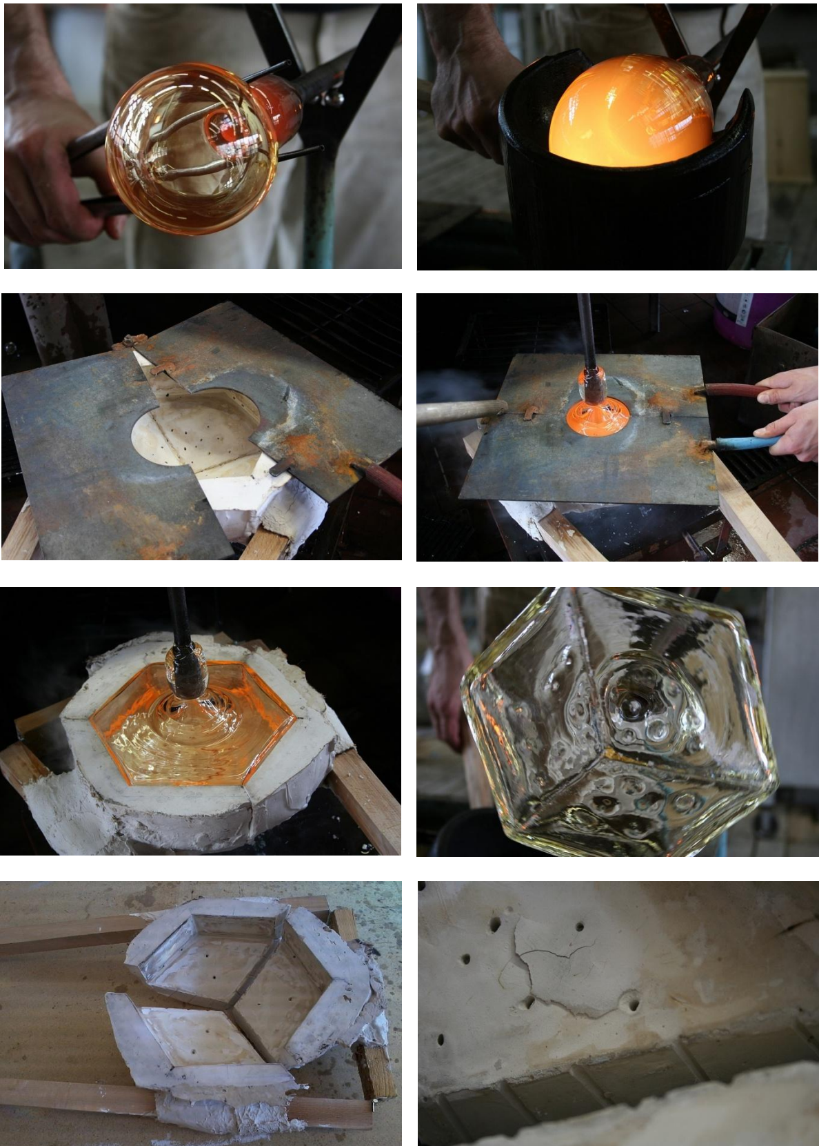
Obr. 52. Postup foukání do sádrové formy
