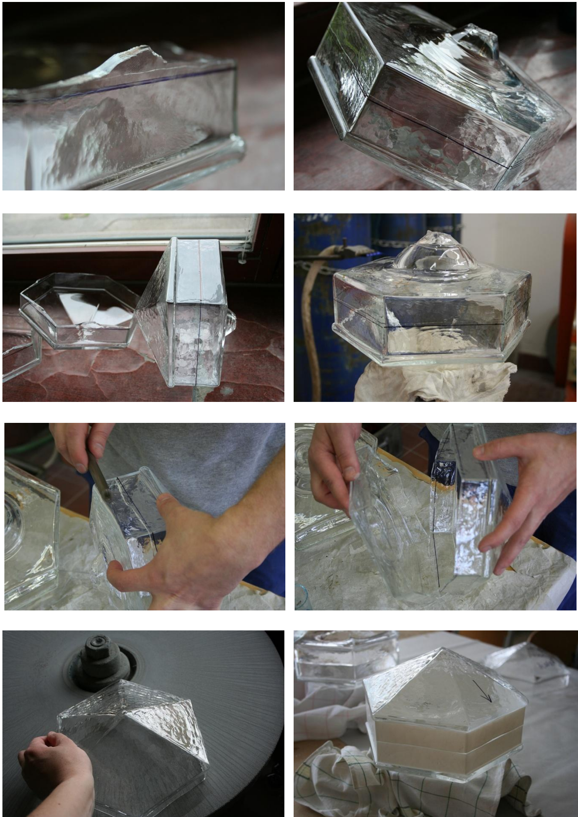
Obr. 56. Odstraňování kopny, broušení a lepení
