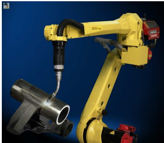
Obrázek 1: Rameno určené ke svařování
