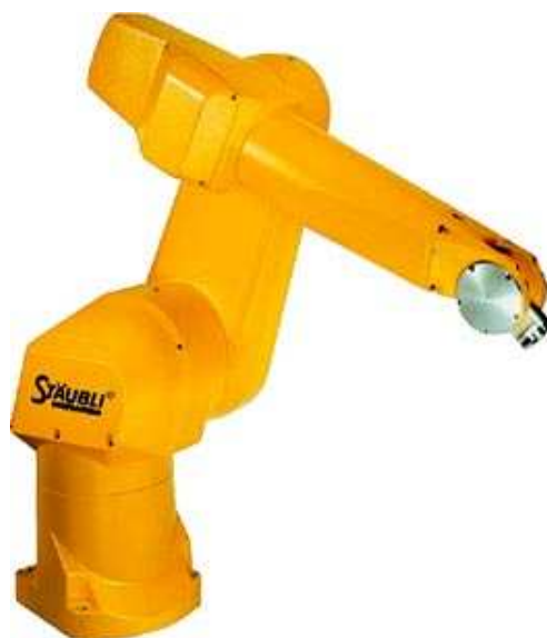
Obrázek 7: Robotické rameno RX170 od firmy Staubli
