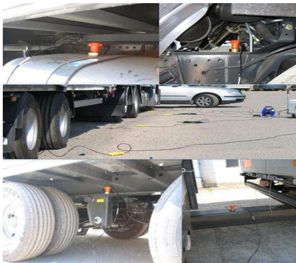
Obr. 22. Osazení snímačů na vozidlo 30
