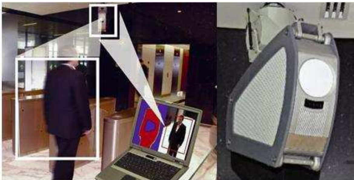
Obr. 31. Sejmутý obraz osoby se skrytým předmětem a vlastní IR kamera 42
