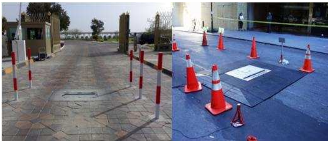
Obr. 25. Vozidlový skener, vlevo – stacionární, vpravo - mobilní 33
