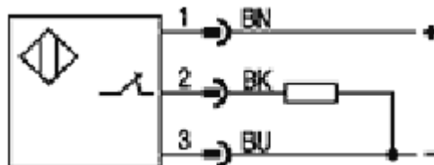
Obr. 13 Schéma zapojení indukčního snímače BALLUFF [5]
