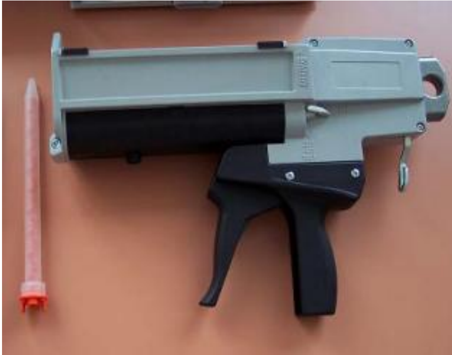
Obr. 11 Aplikátor se statickým mixérem
