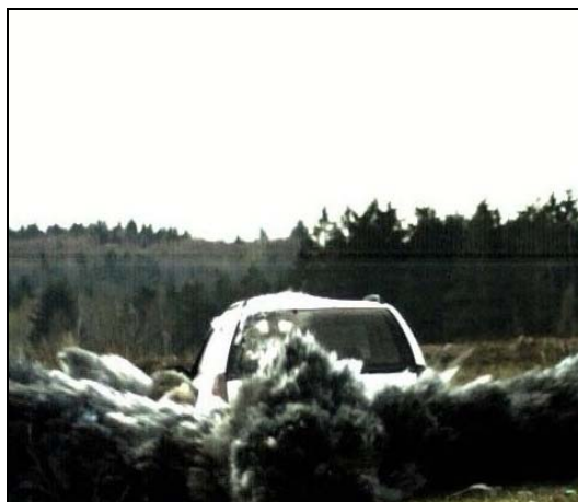
Obr. 37 Destrukce zadního okna
