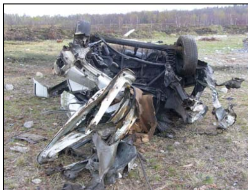
Obr. 29 Zadní část vozidla po odpalu
