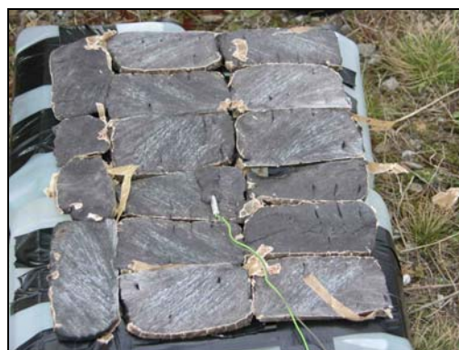
Obr. 27 Kompletní vodní nálož
