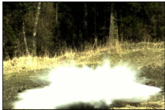
Obr. 51 Šíření tlakové vlny s vodou
