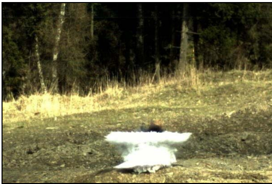
Obr. 50 Šíření tlakové vlny s vodou
