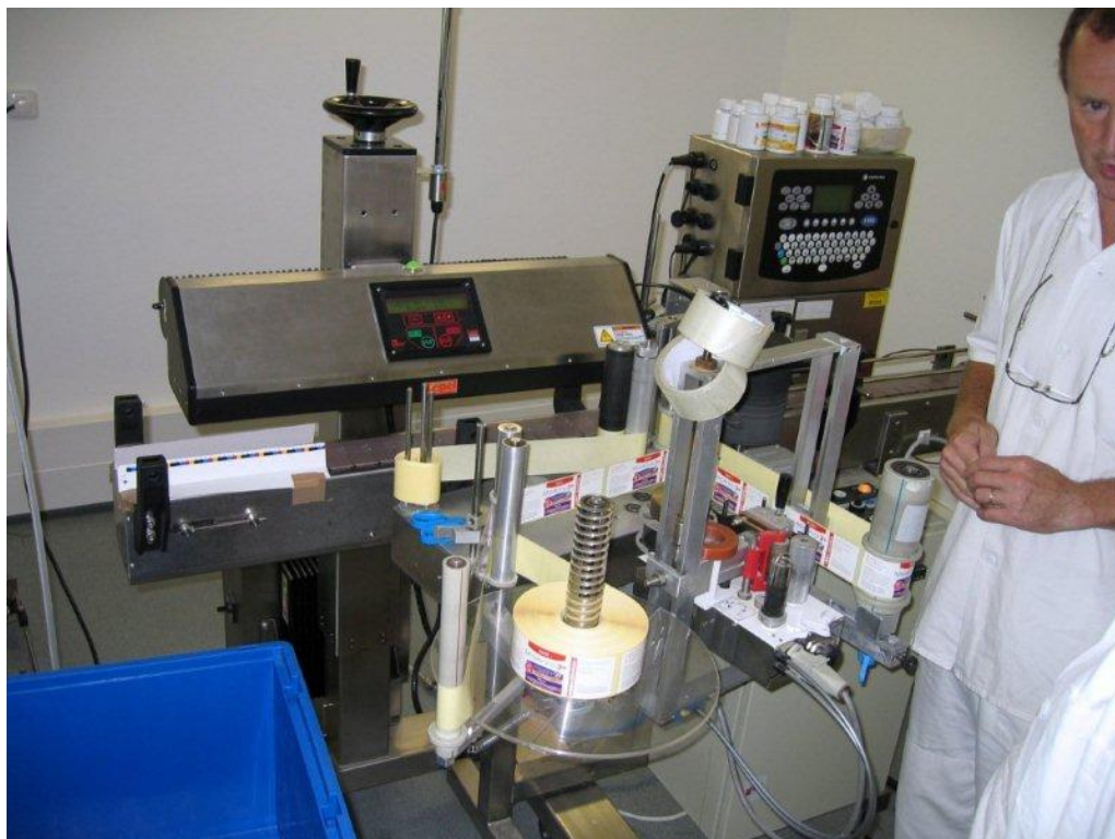
Obr 18. Indukční hlava, etiketovací hlava a ink-jet [zdroj:vlastní]
