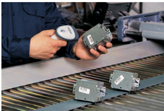
Obr 4. Ukázka sběrného terminálu obsluhovaného manuálně [zdroj:vlastní]
