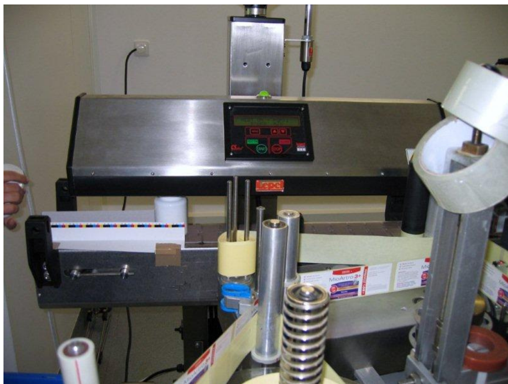
Obr 19: Detail indukční a etiketovací hlavy [zdroj:vlastní]
