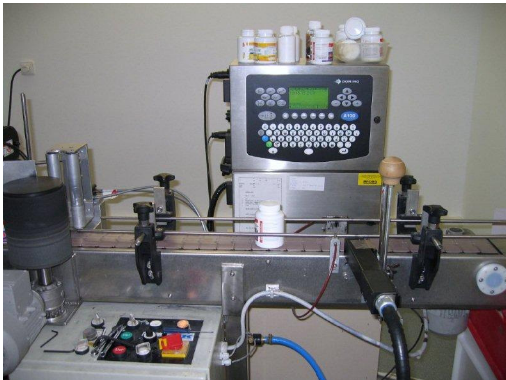
Obr 20. Detail ink-jetu a zahlazování etiket mezi třemi válci [zdroj:vlastní]
