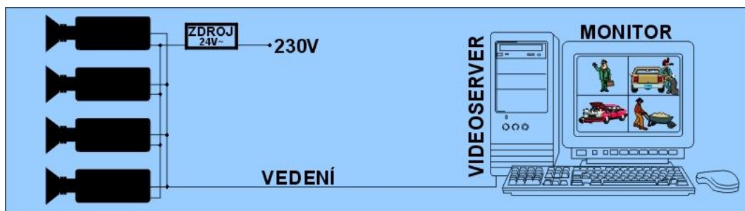
Obr. 2. Schéma kamerového systému [20]
