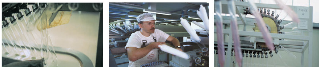
Obr. 1.3 Zobrazenie dnešnej výroby prezervatívov – technika sklenených bánk, ktoré sa namáčajú do gumového roztoku
