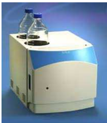
Obr. 5.3: Gelový permeační chromatograf, výrobce Polymer Laboratories
