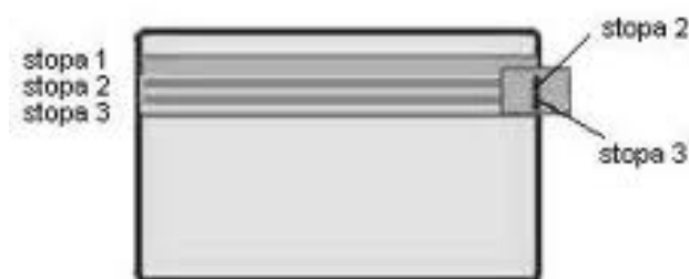
Obrázek 5: Rozložení stop magnetické karty
