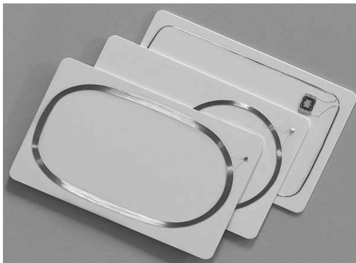
Obrázek 10: Konstrukce klasické bezkontaktní karty
