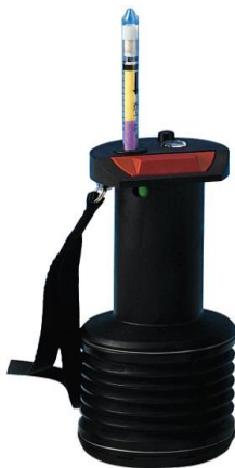
Obr. 9. GAS – Tester II H + detekčná trubička[25]
