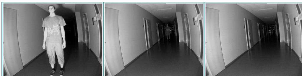
500 W halogen. reflektor – černobílá doma kamera (vzdálenosti 1, 10, 20, 30, 40 m):
