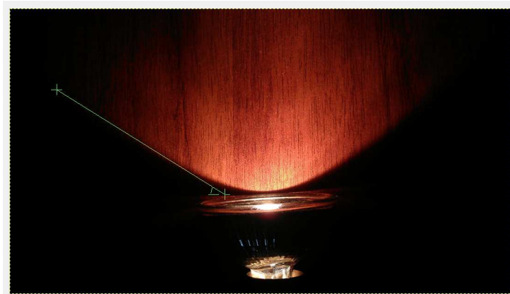
Obrázek 52 – Měření druhého úhlu ( \beta ) na bodovém halogenovém svítidle
