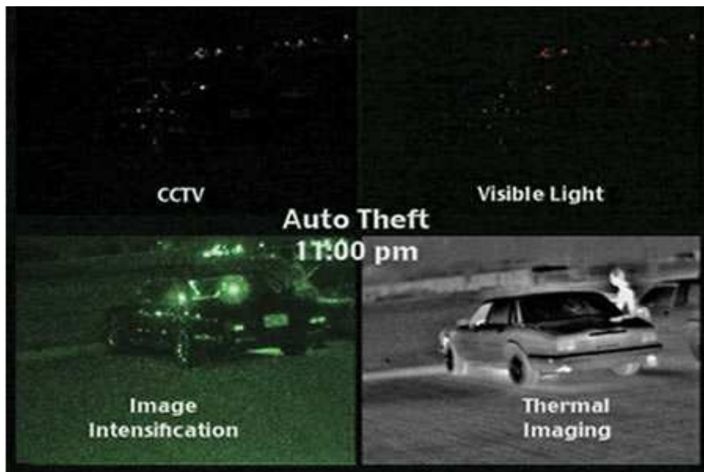
Obrázek 4 – Rozdíly mezi běžným CCTV obrazem, viditelným světlem, použitím noktovize a termálním snímáním [15]
