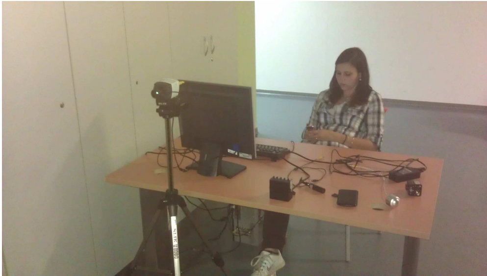
Obrázek 49 – Zbudované pracoviště pro měření dosahu přísvitů pomocí kamery
