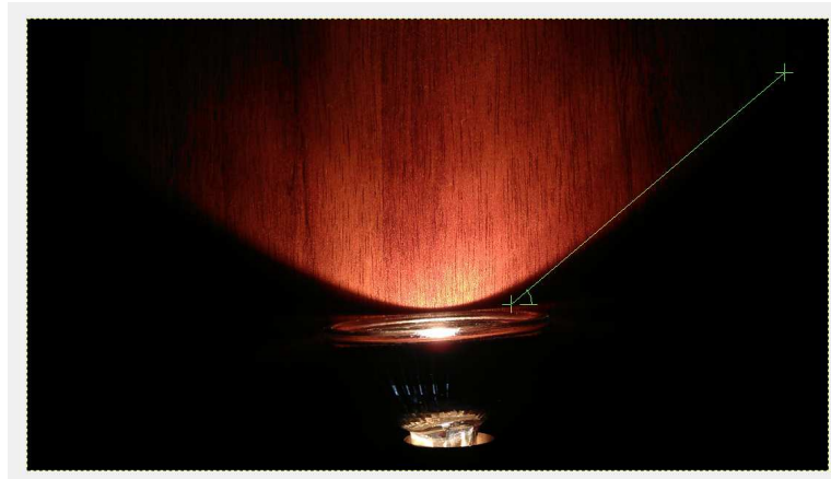
Obrázek 51 – Měření prvního úhlu ( \alpha ) na bodovém halogenovém svítidle
