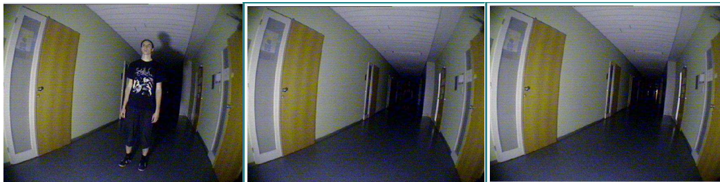
IR LED reflektor – barevná doutníková kamera (vzdálenosti 1, 10 m):
