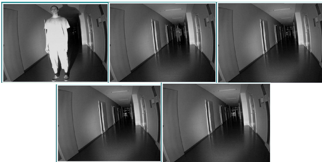
120 W halogen. reflektor – černobílá doma kamera (vzdálenosti 1, 10, 20, 30, 40 m):
