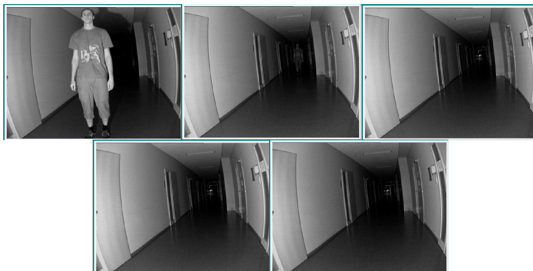
500 W halogen. reflektor – černobílá doma kamera (vzdálenosti 1, 10, 20, 30, 40 m):
