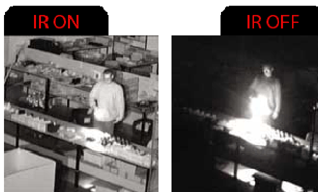
Obrázek 3 – Rozdíl snímku se zapnutým a s vypnutím IR přísvitem [14]
