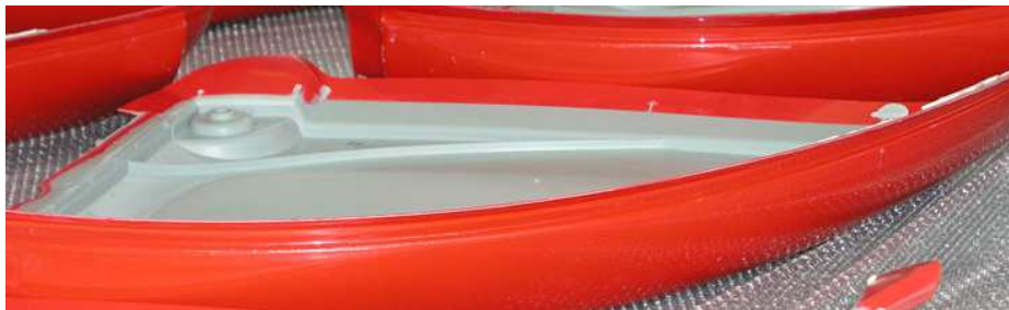
Obr. 21. Vyztužování za pomoci vypěnění dutiny plastu [8]
