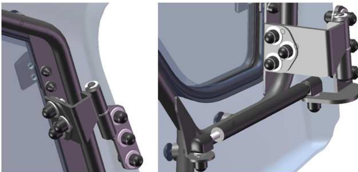
Obr. 54. Horní pant, spodní pant + plynová vzpěra 300N
