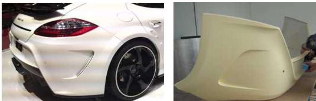
Obr. 14. T-Design, nárazník vytvořený pomocí technologie RRIM [12]
