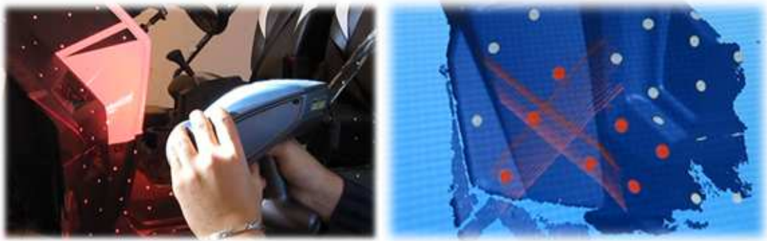
Obr. 30. VXscan – ukázka detailu z digitalizace levé přední části
