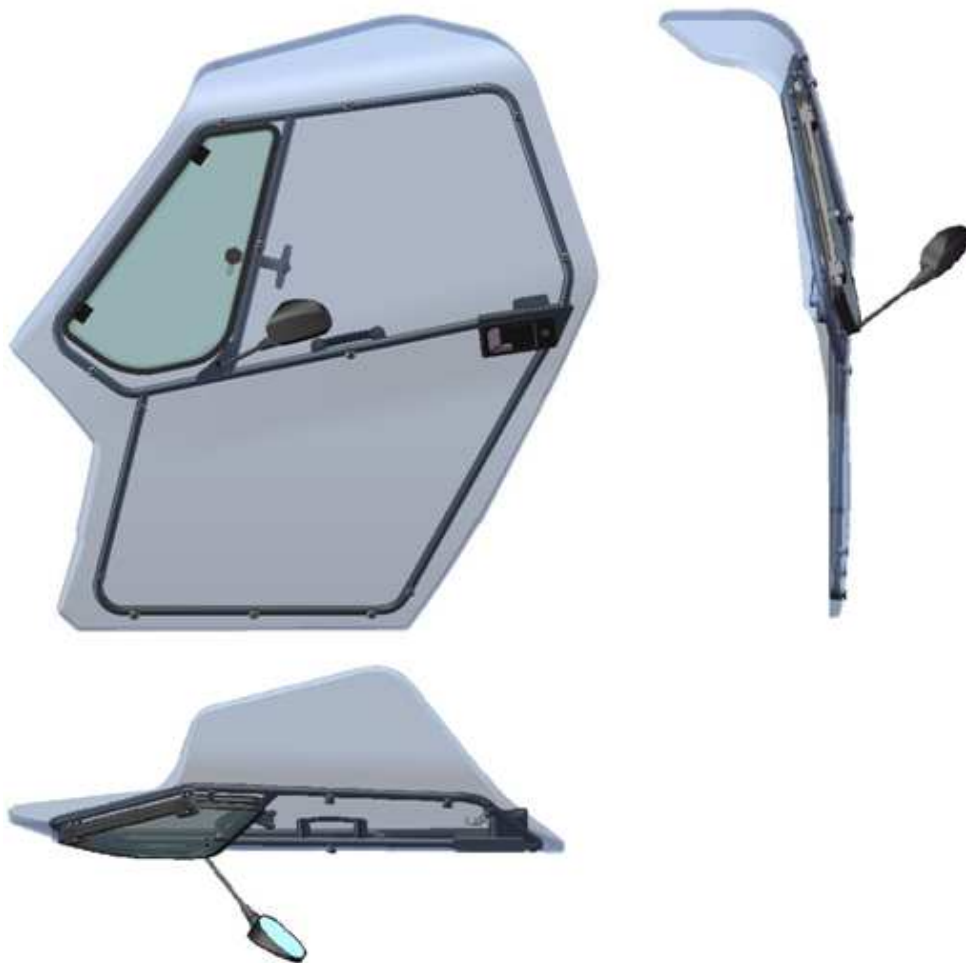
Obr. 47. Konstrukční návrh dveří terénní buginy
