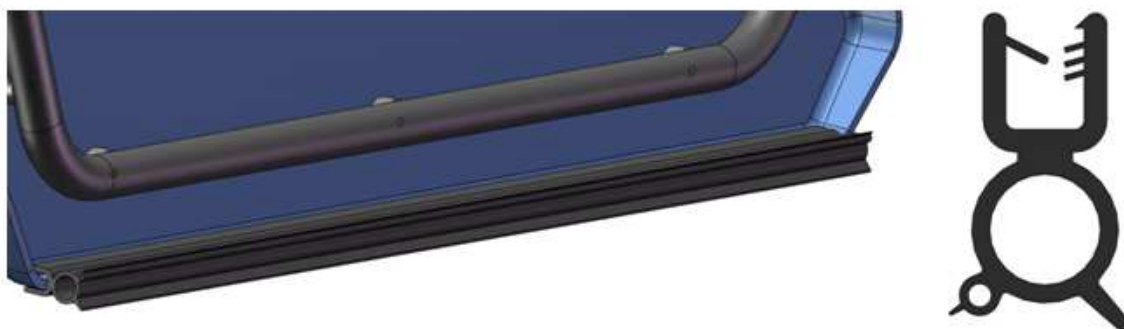
Obr. 57. Těsnění po obvodu dveří a jeho profil
