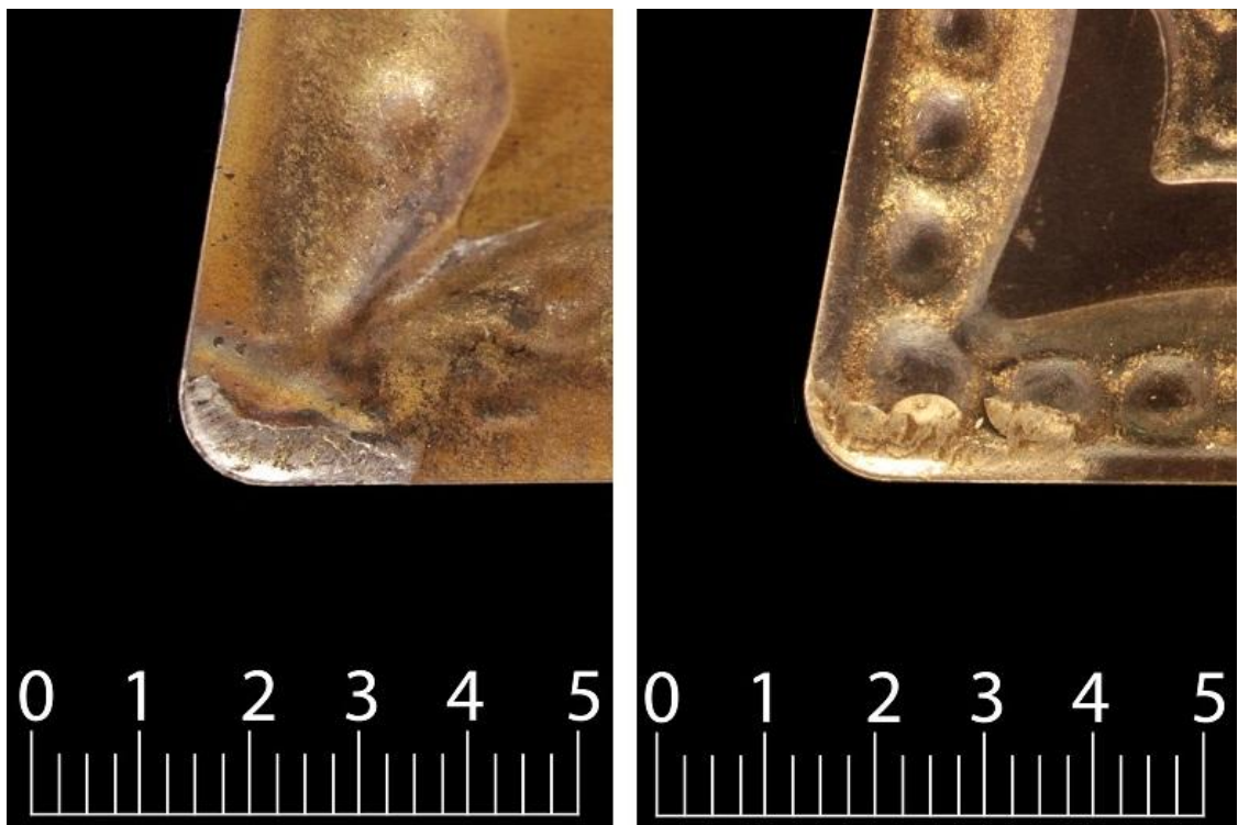
Obr. 37 Porovnání opotřebení čela po 11,5 minutách obrábění
