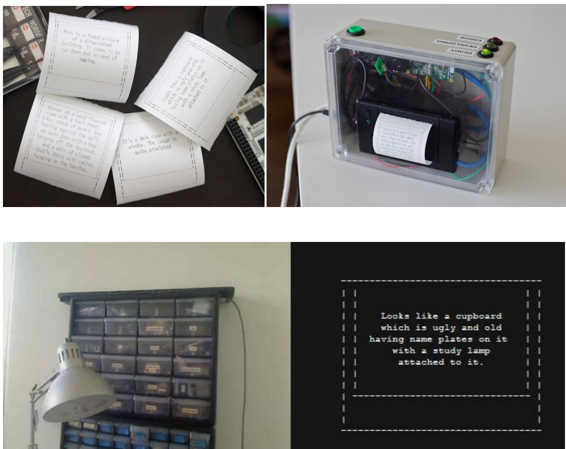
Obr. 74. Ukázka prototypu fotoaparátu, tisknoucí text
