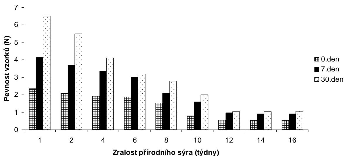
Obr. 4.17: Závislost tvrdości vzorku s 1,0 % w/w AK (100:0) na zralosti použité suroviny a době skladování ( 6 \pm 2 °C)
