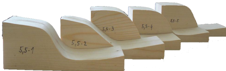
Obr. 8. Profily formy z dreva pre výšku podpätku 55 mm.
