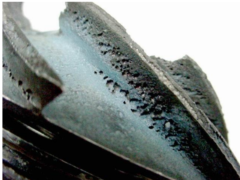
Obr. 26. Kavitační opotřebení – lopatkové kolo
