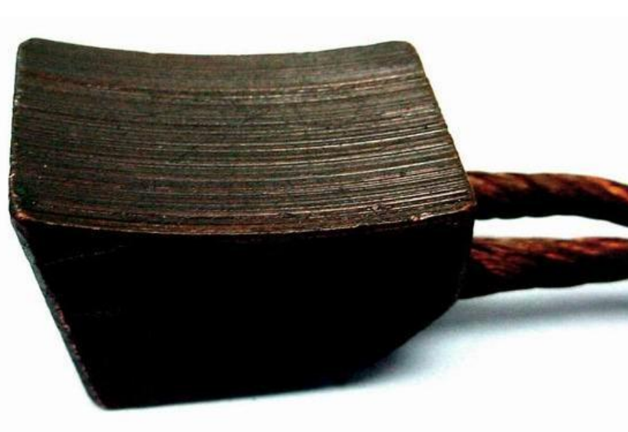
Obr. 18. Abrazivní opotřebení - uhlík elektromotoru
