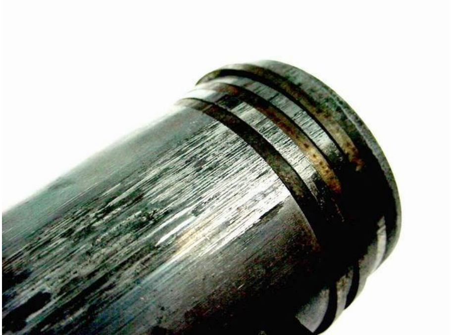
Obr. 17. Abrazivní opotřebení - píst spalovacího motoru
