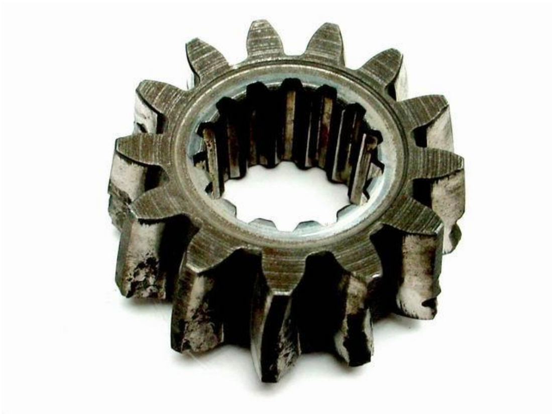
Obr. 24. Únavové opotřebení – ozubené kolo
