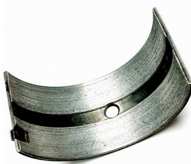
Obr. 15. Adhezivní opotřebení - ojniční pánev
