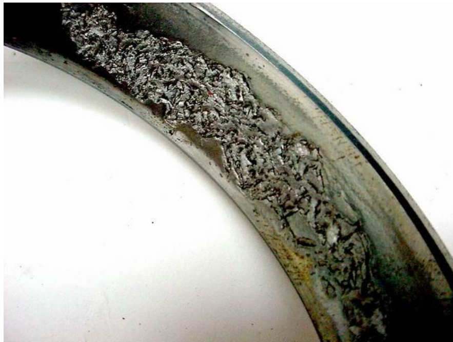
Obr. 23. Únavové opotřebení - kroužek ložiska
