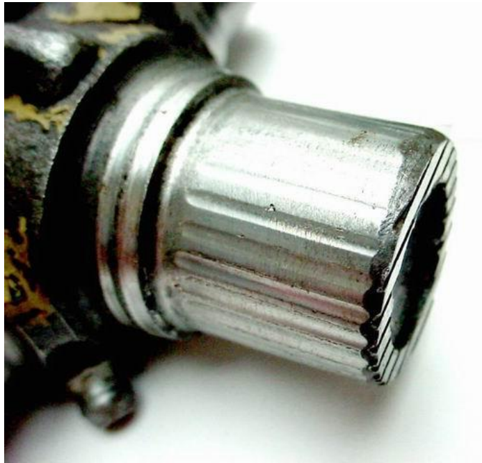
Obr. 28. Vibrační opotřebení – kříž
