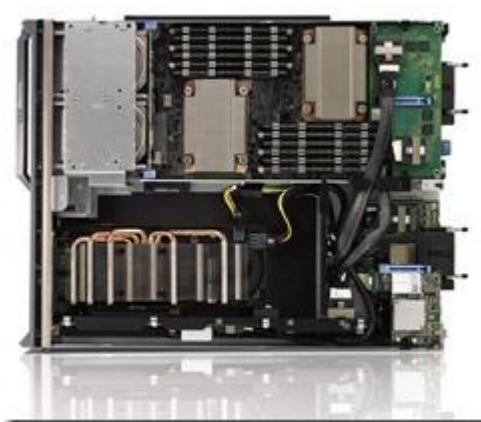
Obr. 5 Speciální úprava serveru s přidanou kartou [2]
