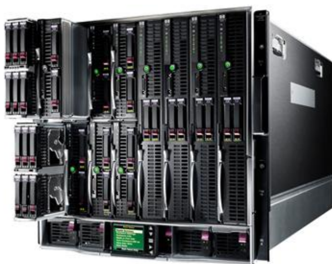
Obr. 2 Detailní pohled na chassis blade a na vysunuté servery [21]
