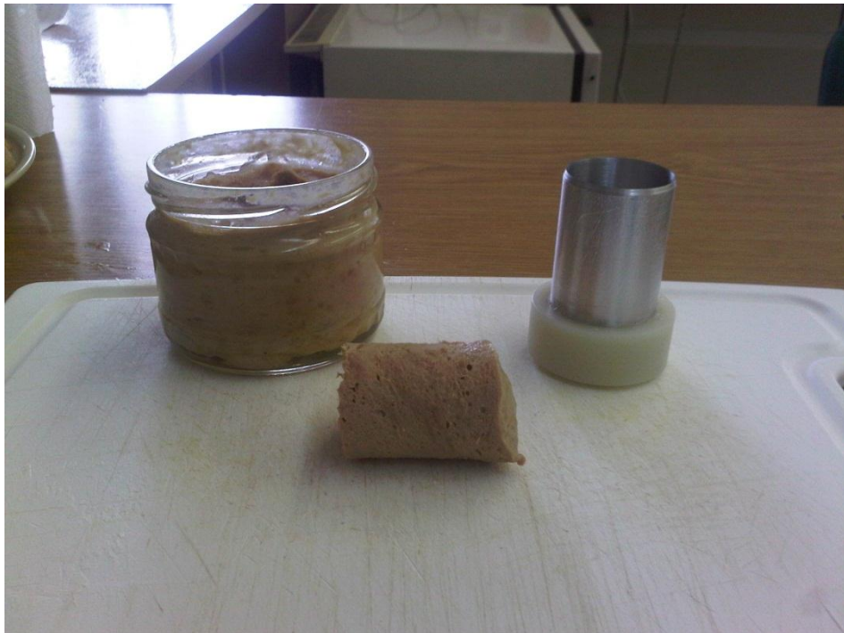
Obrázek 5 Střední výkroj použitý k měření textury
