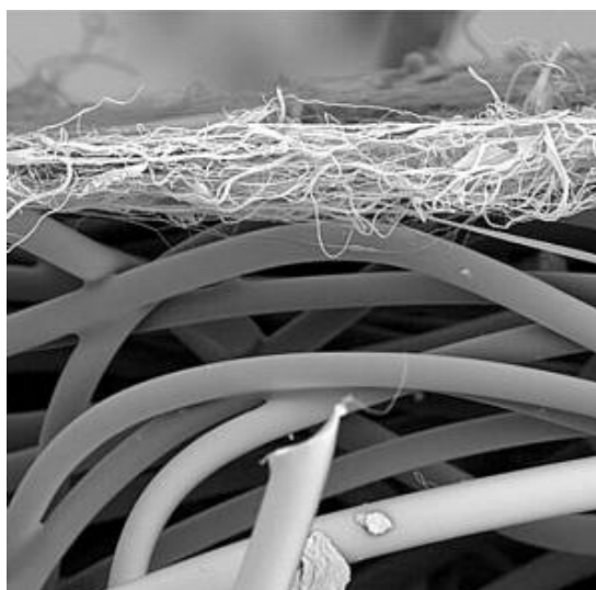
Obr. 11. Snímek zvukově pohltivého materiálu z nanovláknenné vrstvy nanosené na vláknennou netkanou textilií [16]
