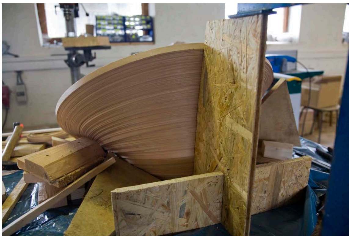
Obrázek 33. Tvarování zádové opěrky
