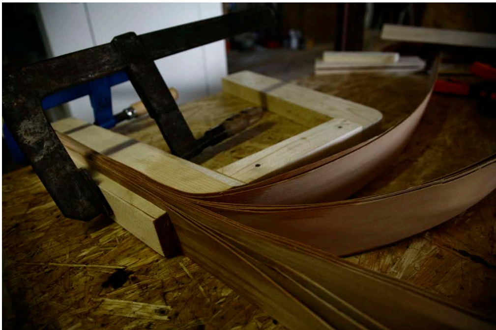
Obrázek 36. Tvarování předních nohou
