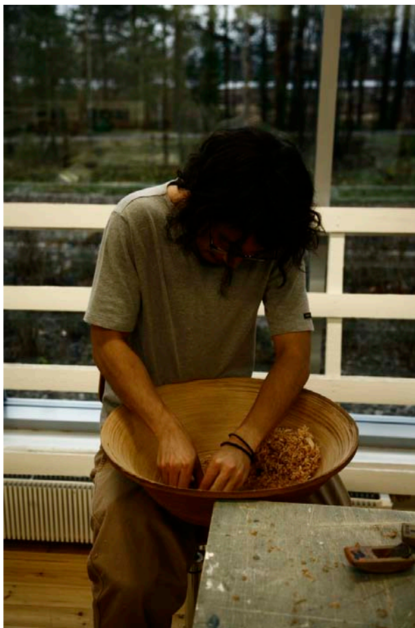
Obrázek 8. Hoblování vnitřní strany mísy na rýži
