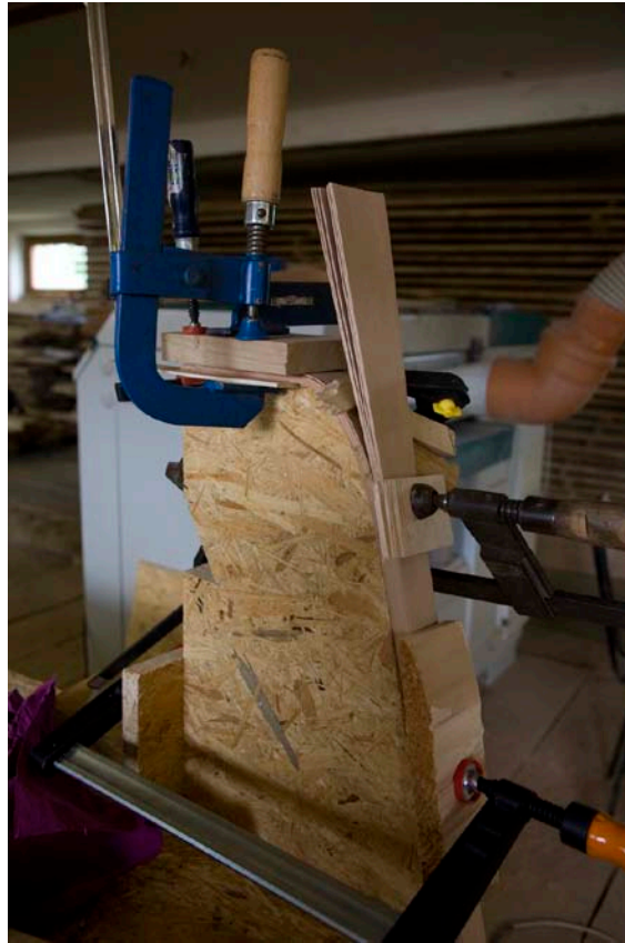
Obrázek 37. Ohýbání zadních nohou
