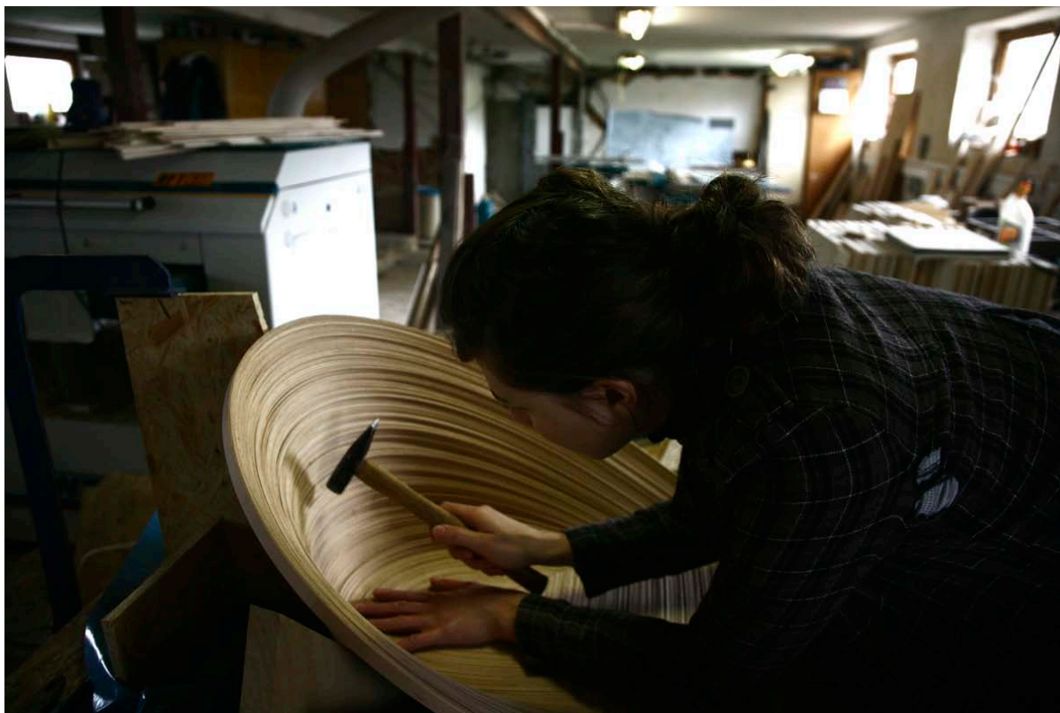
Obrázek 34. Vyrovnávání dýhových vrstev
