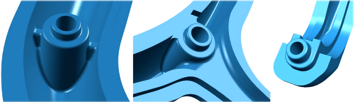
Obrázek 47. Řešení montážních nálitků v místech spoje nýty
