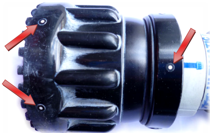
Obrázek 14. Referenční body nalepené na skenovaném objektu
