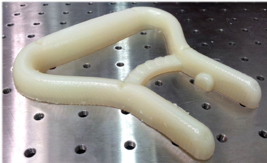
Obrázek 107. Hotový model obalený podpůrným materiálem
