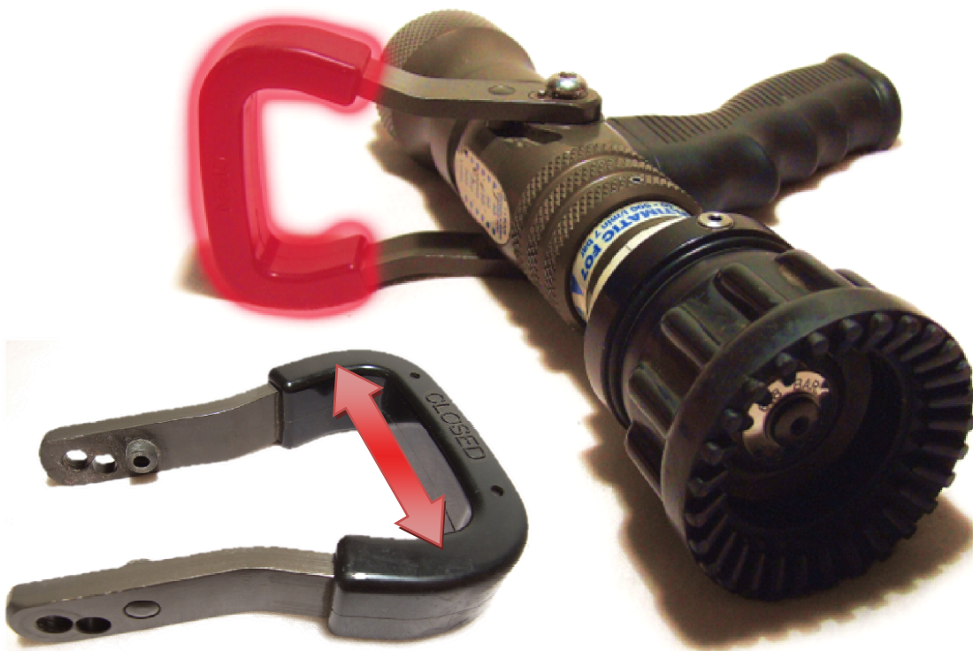
Obrázek 12. Ovládací madlo proudnicе s vyznačením nevhovujícího rozměru
