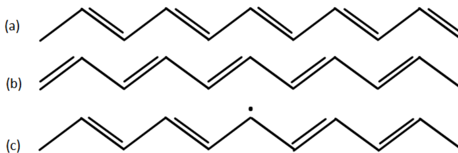
Obrázek 3 – (a) a (b) dvě možné formy konjugace a (c) vzniklý defekt na řetězci trans – polyacetyleny, překresleno podle [8].
