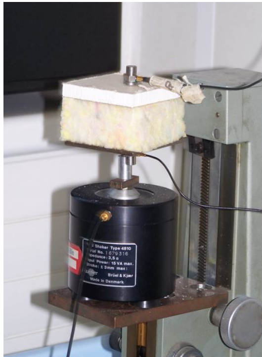
Obr. 37 REC + S během měření buzené vibrátorem
