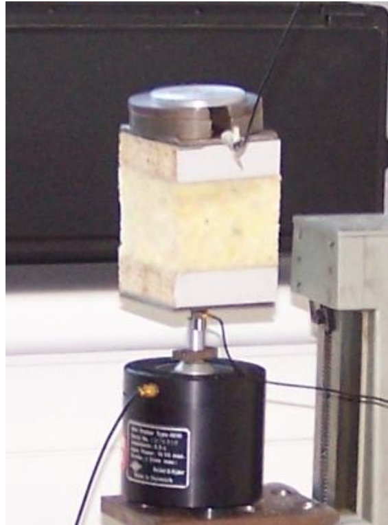
Obr. 47 DT + REC + DT Z během měření buzené vibrátorem
