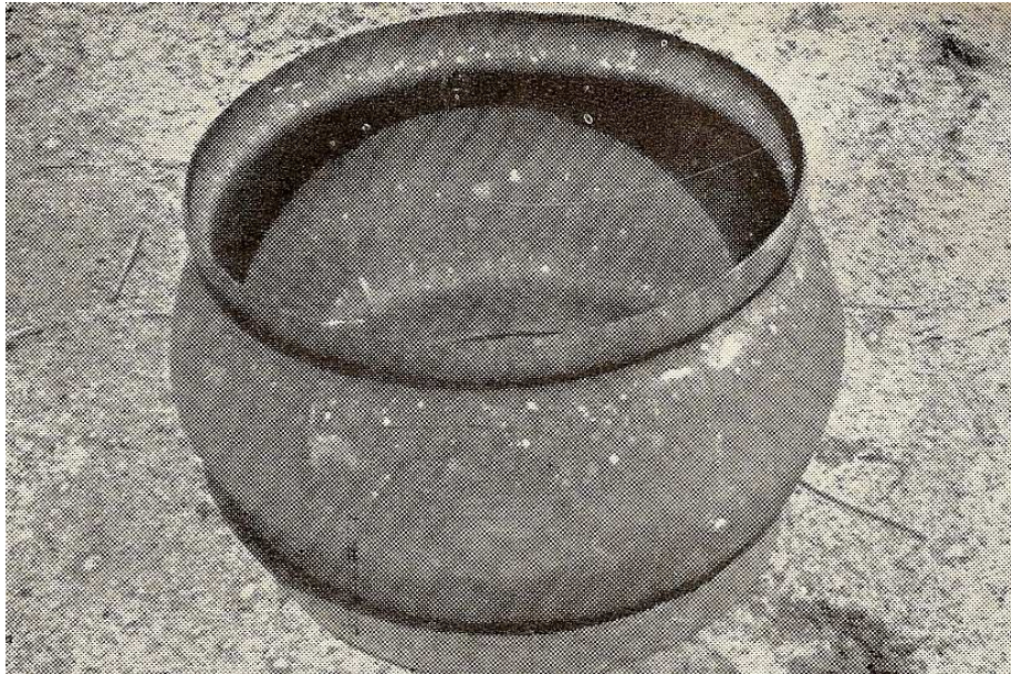
Obr. 7.1 Výlisek přepravního sudu tvářen technologií pomocí výbuchu [4]
