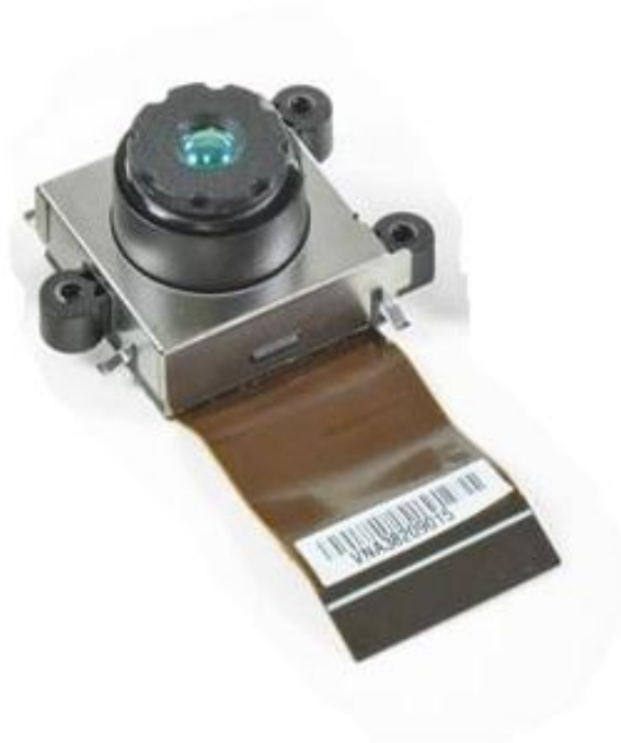
Obrázek 11: Monochromatický CMOS snímač [13]
