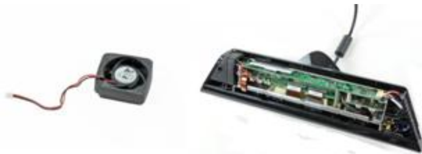
Obrázek 12: Elektronické desky a ventilátor [13]
