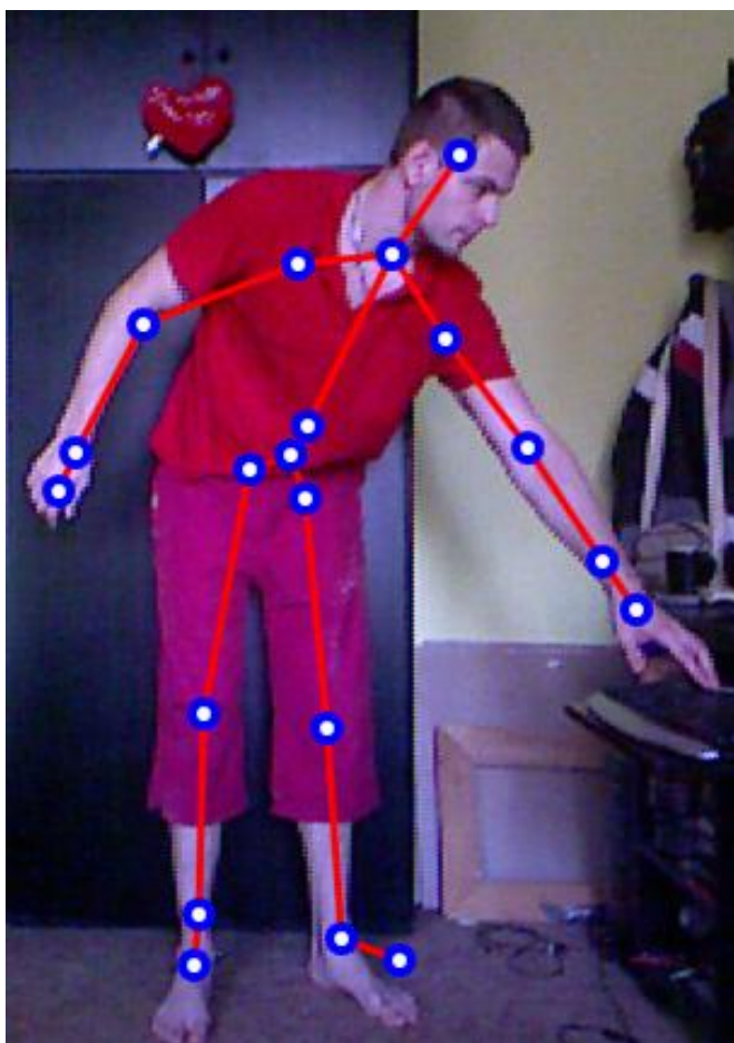
Obrázek 30: Chybné určení pozice jointu
