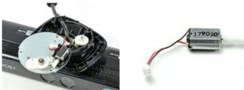
Obrázek 8: Motorizovaná základna a elektromotorek [13]
