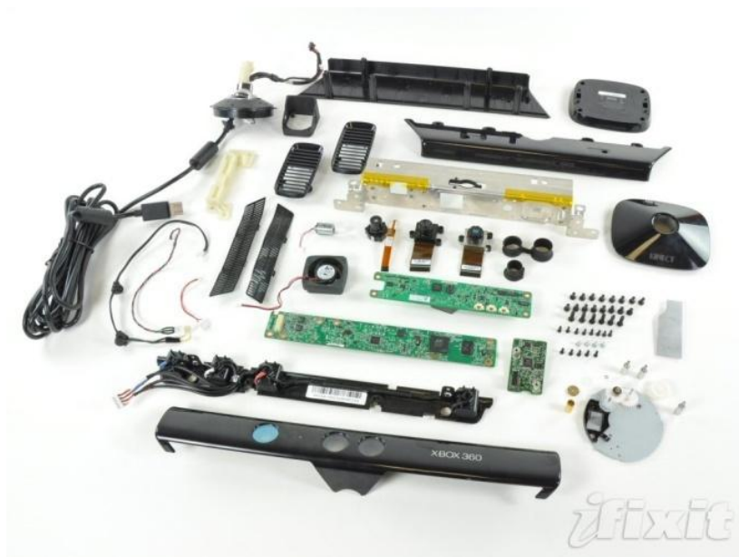
Obrázek 7: Rozebraný senzor Kinect [13]
