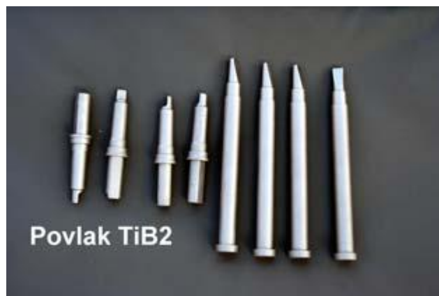
Obr.20. Ravníky – povlak \text{TiB}_2 nanesený metodou PACVD
