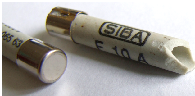
Obrázek 34. Prasklé keramické tělo pojistky
