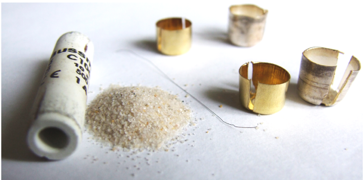
Obrázek 35. Rozebraná tavná keramická pojistka
