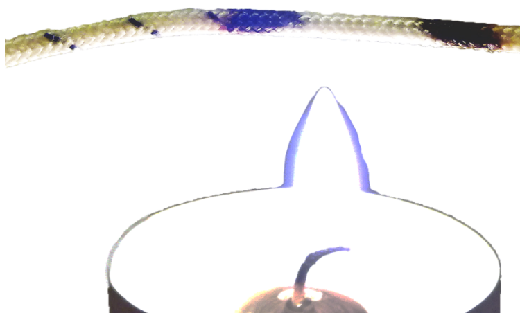
Obrázek 77. Vystavení izolace termočlánku přímému plameni svíčky
