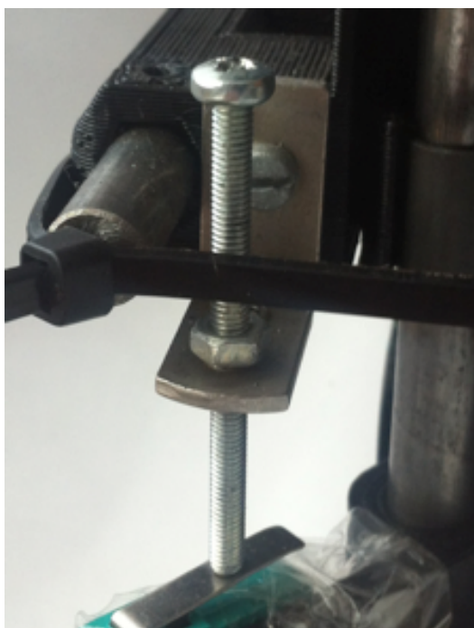
Obr. 26 Dilatační šroub pro polohování Z osy
