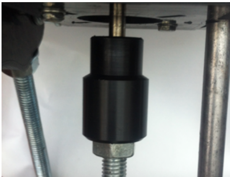
Obr. 29 Spojení mezi motorem Z osy a závitovou tyčí
