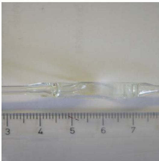
Obr. 11. Kolektor s bodem stagnace toku se šikmou tryskou [5].
