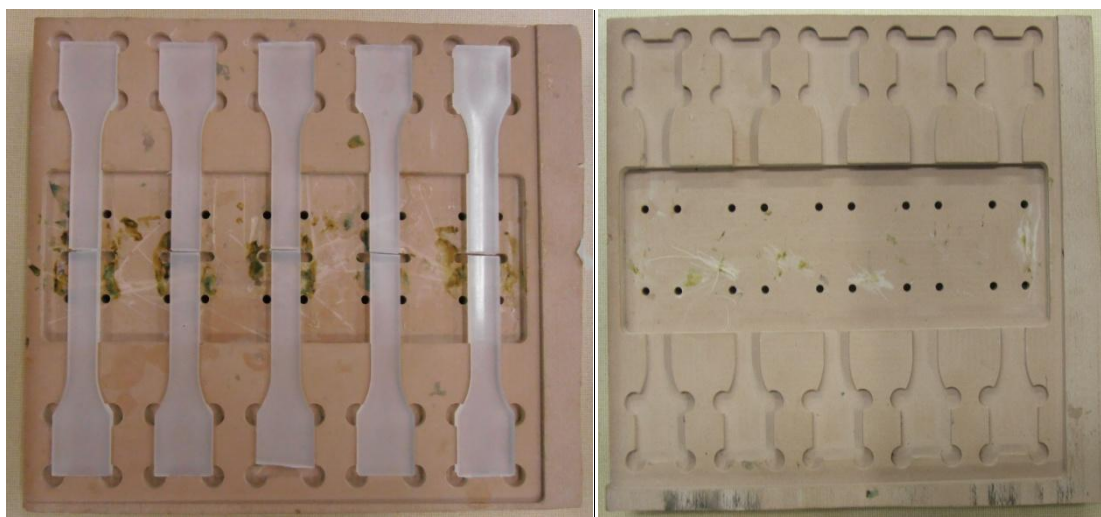
Obr. 27. Přípravky sloužící k přesnému a kvalitnímu slepení vzorků.
