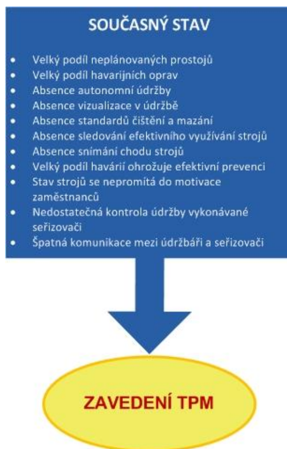
Obrázek 28: Současný stav údržby ve společnosti Epcos s.r.o. a možné východisko. (vlastní)
