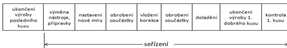
Obr. č. 6: Čas seřízení stroje a zařízení (upraveno z Košturiak a Frolík, 2006, s. 107)
