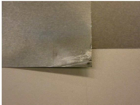
Obrázek 20: Příklad poškození spodní desky (interní zdroj)
