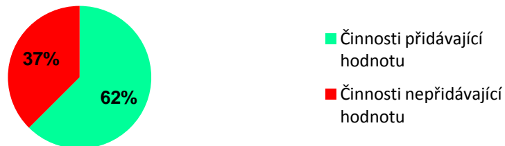
Obrázek 15: Procentuální vyjádření činností přidávající hodnotu při řezání desek 629 x 485 mm (vlastní zdroj)
