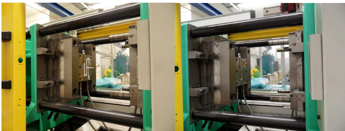
Obr. 16 Otevřená vstřikovací forma s umístěným výrobkem a bez něj.
