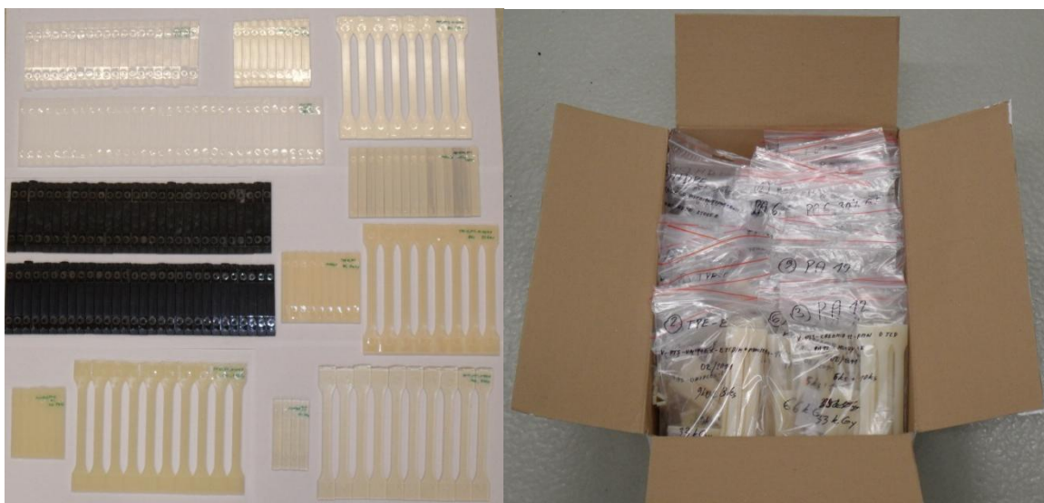
Obr. 17 Roztříděné série zkušebních tělísek, označení a uložení při přepravě.
