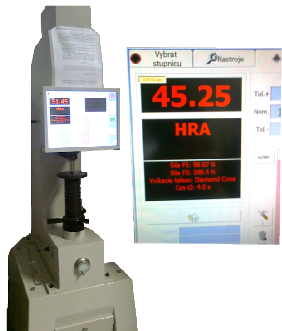
Obr. 42. Měření tvrdosti HRA
