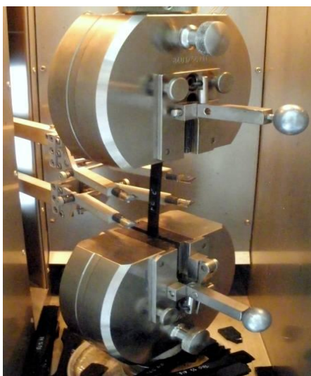
Obr. 37. Upnutí tělíska na trhacím stroji
