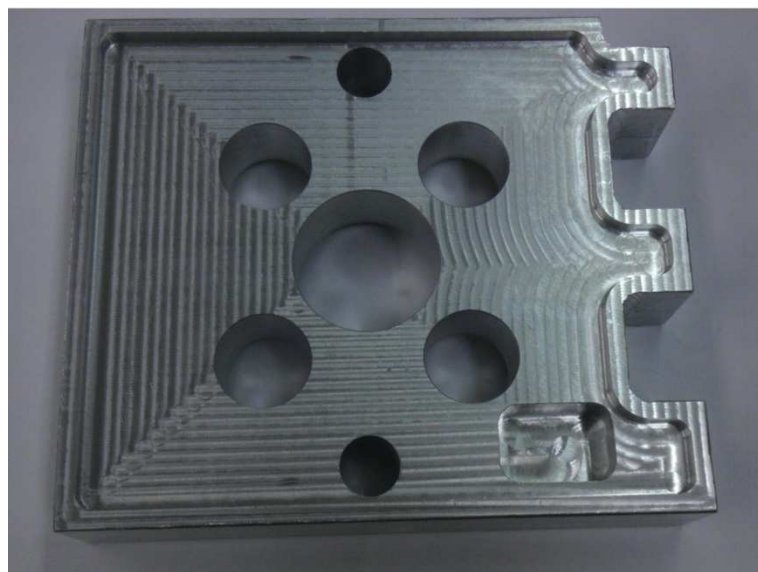
Obr. 28 Hotový a očištěný dílec
