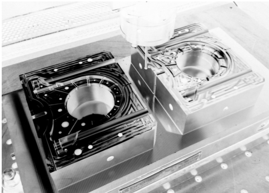
Obr. 35. Vyrovnání tvárníků před EDM.
