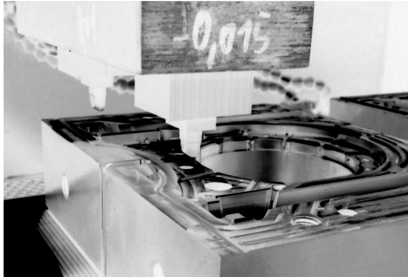
Obr. 43. Kontrola zadaných souřadnic, elektroda pro zácvky.
