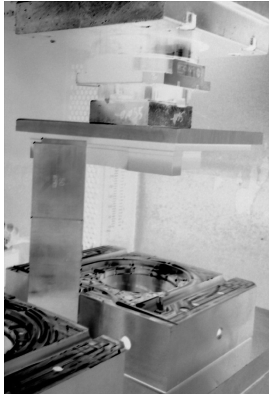
Obr. 37. Najíždění elektrod v ose Z před EDM.
