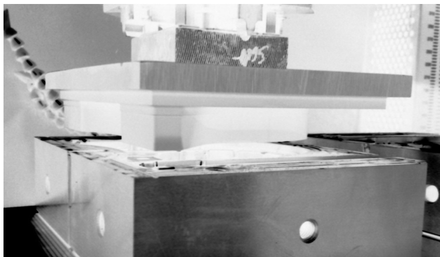
Obr. 42. Kontrola zadaných souřadnic, elektroda pro žebra.
