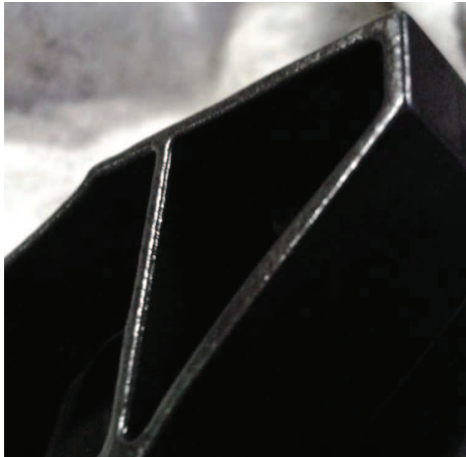
Obr. 47. Opotřebovaná elektroda pro žebra.
