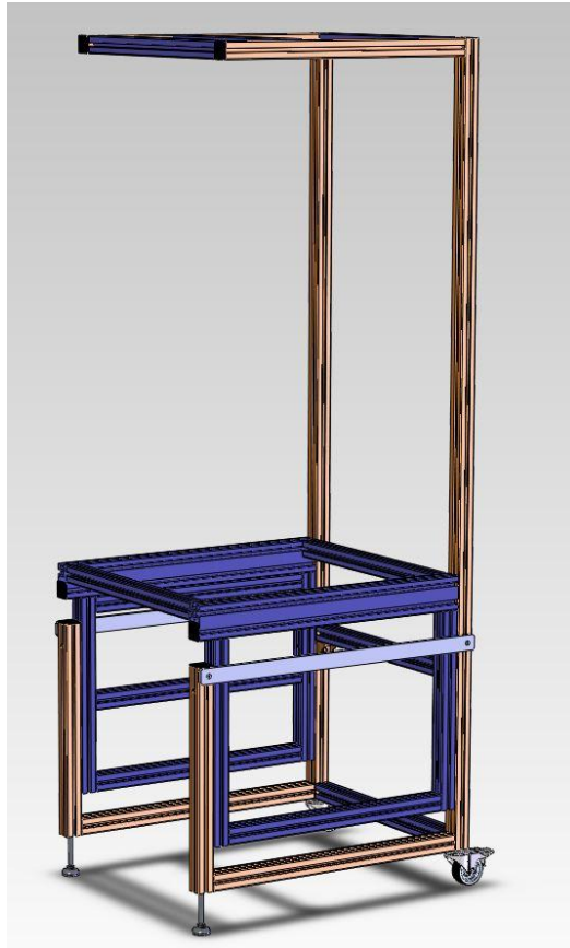
Obr. 70. Rám s pohyblivou pracovní rovinou
