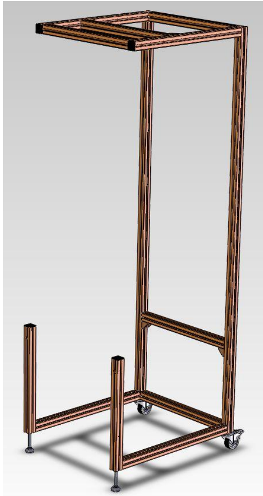
Obr. 69. Páteřová konstrukce rámu
